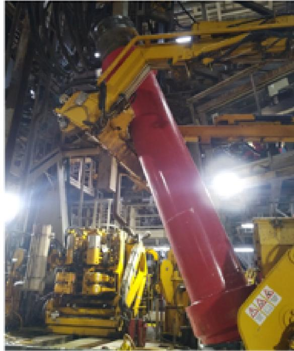
Det ble raskt klart at running tool ikke var korrekt montert fra land og at dette ikke var blitt identifisert på sjekker gjort av TFMC før kjøring av riser joint. TFMC sjekket riser og running tool for skader, og TFMC informerte at det ikke var skader på running tool eller seal flater. Vi ble enig om å montere running tool tilbake på riser.
