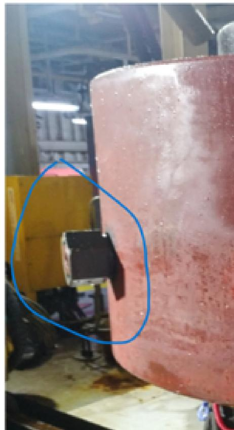
Her vises at man kunne skru inn locking dog 2 ¾ turn etter rise hadde falt ut og det vises også at bolt er nå uten gap til body på running tool. Bildet under viser hvordan bolt til dog stod etter at riser falt ut av running tool.
